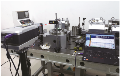
Измерение угла индексирующей пластины с числовым программным управлением
